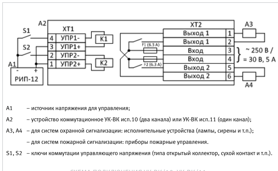
СХЕМА ПОДКЛЮЧЕНИЯ УК-ВК/10, УК-ВК/11
